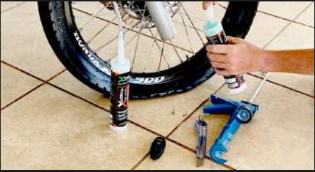
Encaixar e rosquear a mangueira de aplicação no frasco.
