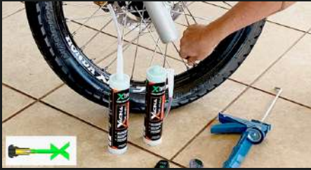
Remover o núcleo de válvula usando o chaveiro saca-válvula incluso no kit.
