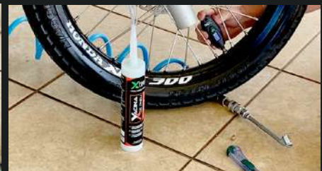
Calibrar com a pressão de ar usada regularmente.
