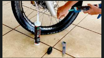
Retirar a ponta da mangueira da válvula de ar.
