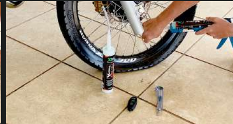
Encaixar firmemente a ponta da mangueira na válvula de ar do pneu.
