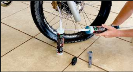
Encaixar o frasco na pisto aplicadora de silicone (não inclusa no kit).
