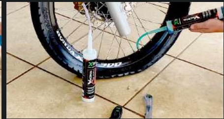
Aplicar todo o conteúdo do frasco lentamente para evitar vazamentos.
